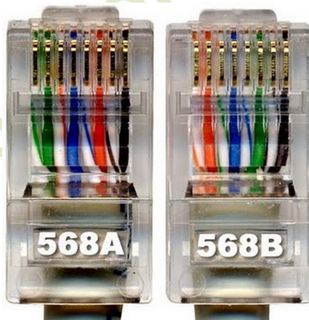
Kabel UTP yang sudah terpasang dikonektor RJ45
